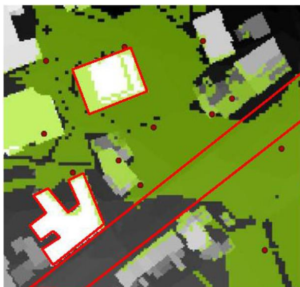
شکل ۵. نقشه پوشش و جایابی ۱۲ حسگر با استفاده از روش محیط آگاه، با توجه به خیابان و ساختمان به‌عنوان منطقه ممنوعه (مناطق قرمز رنگ) منبع: نگارنده
